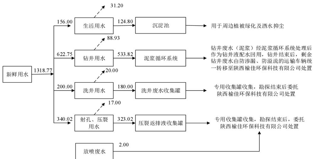
图 2-4 项目水平衡图 (单位: m<sup>3</sup>/施工期)
