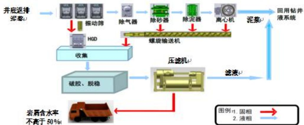
图2-5 泥浆循环系统工艺流程简图
