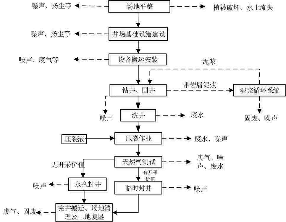
图2-7 项目主要工艺流程及产污环节
